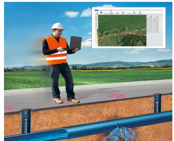
*El navegador de fugas guía al operador a la posición de la fuga a través del gps*
