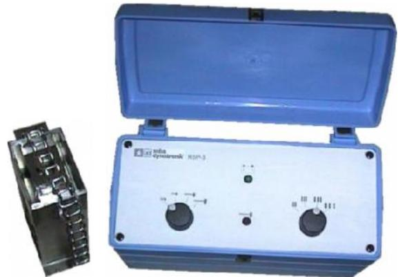
Un desarrollo de un equipo portátil para la localización acústica de tubos subterráneos especialmente tubos no metálicos. Muy fácil de instalar.
